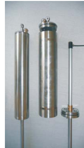
Stangenextensometer mit Messkopf und Anker für Oberflächenmontage, Wegaufnehmer sowie digitalem Ablesegerät
