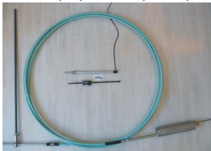
Stangenextensometer mit Messkopf und Anker für Oberflächenmontage, Wegaufnehmer sowie digitalem Ablesegerät
